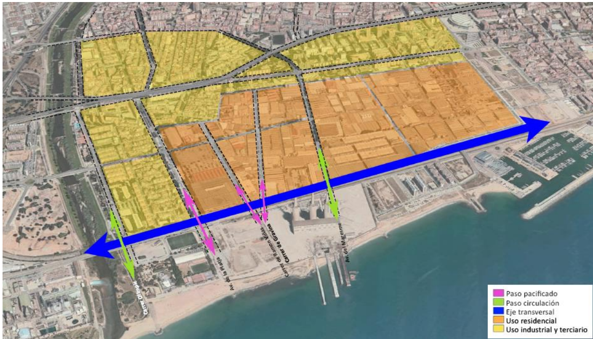
Ilustración 68. Esquema de conexiones transversales y longitudinales diseñadas para la av. Eduard Maristany. Fuente: Elaboración propia
