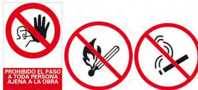
Figura 4. Prohibit el pas a tota persona aliena a l'obra, encendre foc i fumar
