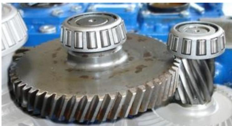
**Figura 1.6.** Engranajes helicoidales. (Fuente: [www.mecapedia.uji.es](http://www.mecapedia.uji.es))
