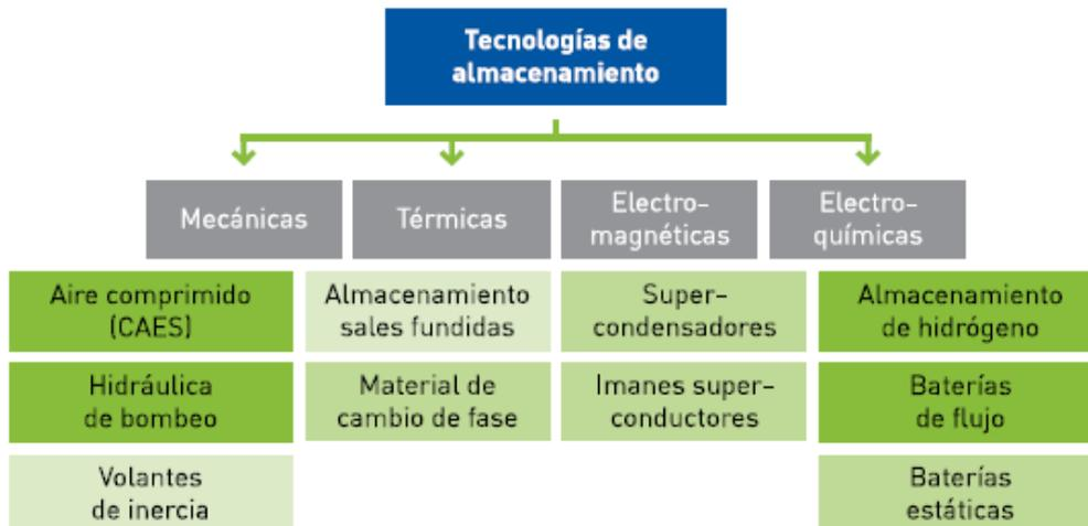
Figura 9 - Tipologias de tecnologias de armazenamento de energia elétrica
