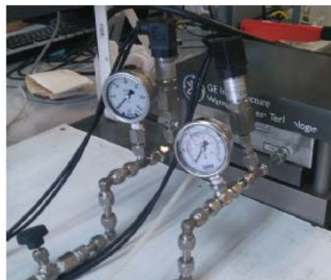
Fig 21: Manòmetres col·locats en l'entrada i la sortida del mòdul de membrana
