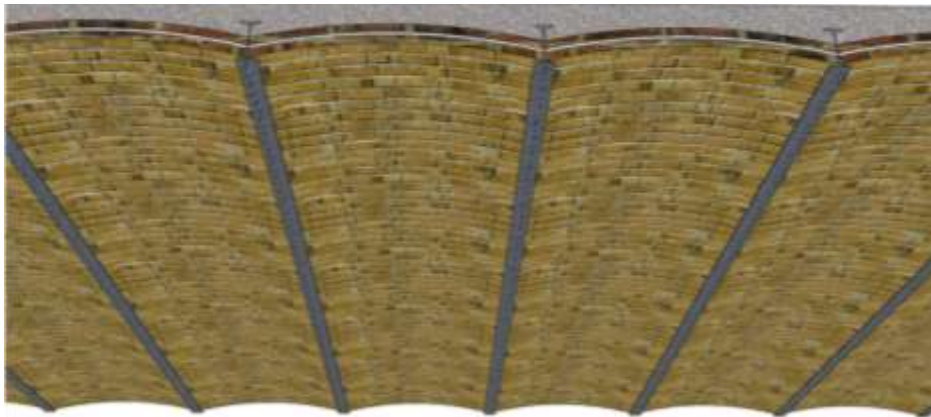
Figura 10: Forjado tipo de un edificio del Eixample
