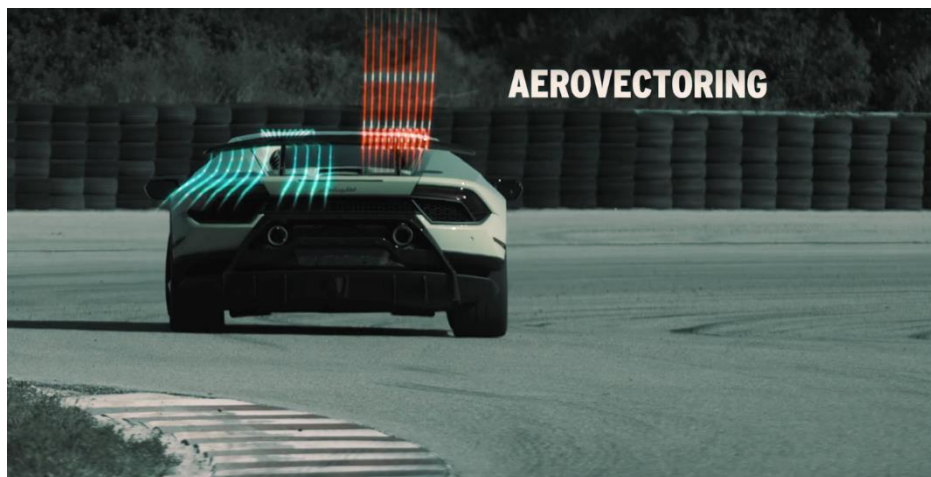
Figura 4.4. Funcionamiento de ALA en una curva de derechas.
