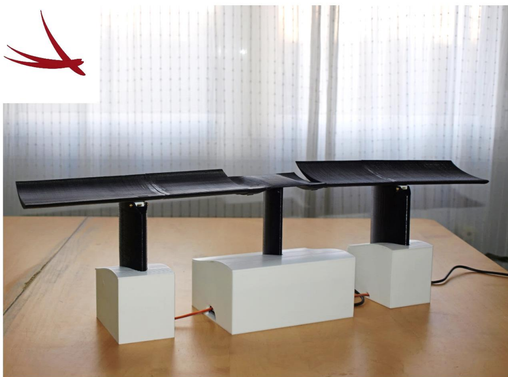
Figura 9.4. Maqueta real a escala del sistema aerodinámico activo.
