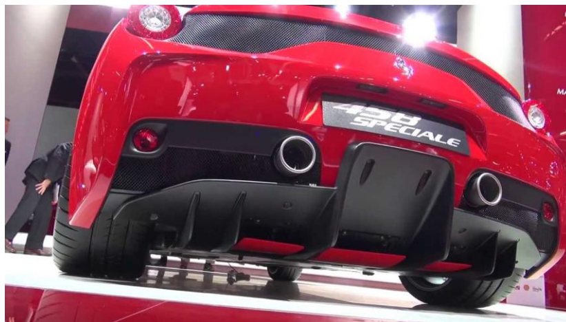
Figura 4.2. En rojo, los flaps del difusor trasero del Ferrari 458 Speciale.
