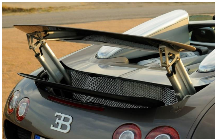
Figura 4.1. Alerón trasero del Bugatti Veyron.
