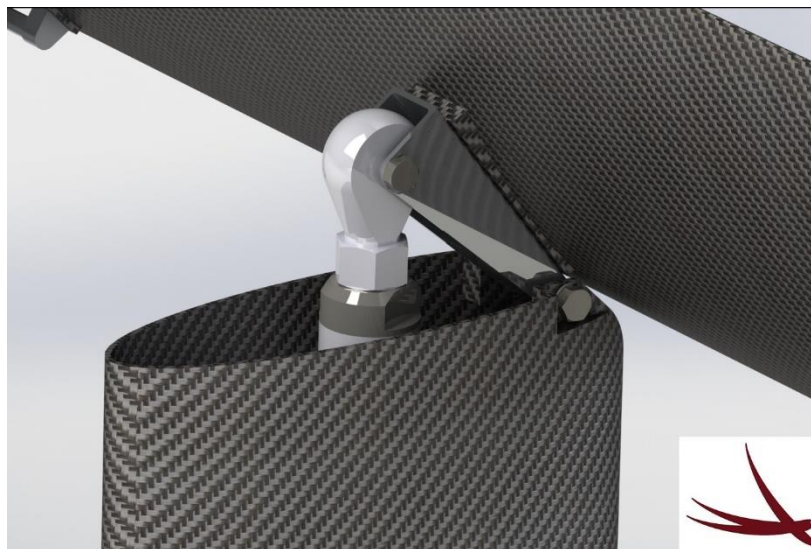
Figura 4.21. Conjunto formado por rocker , soporte y actuador con sus uniones.
