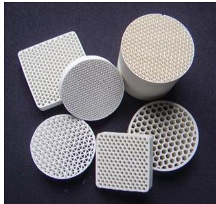
Figura 3.10: diferents formes de regeneradors honeycomb 9
