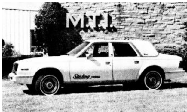
Figura 3.11: prototip de cotxe desenvolupat per MTI i la NASA, propulsat per un motor Stirling 10
