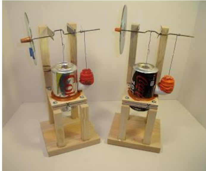
Figura 3.5: motor Stirling construït amb una llauna de refresc 5
