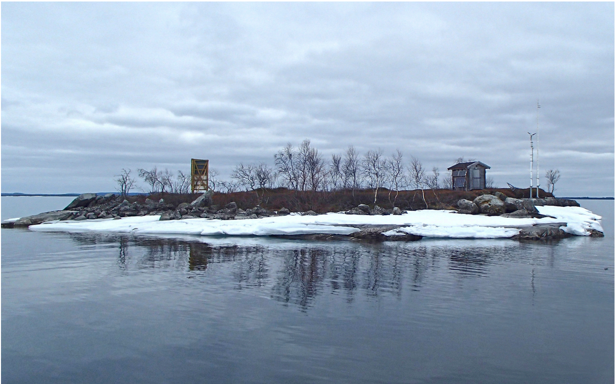
Seitältaassan säähavaintoasema Inarijärven Kasariselällä. Meteorologisten muuttujien lisäksi asema mittaa myös selkävesien pinta-veden lämpötilaa avovesikaudella mittauspuomin ja -poijun avulla. Kuva Erno Salonen.
