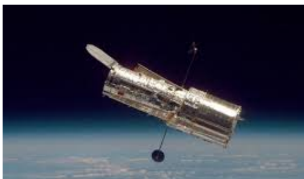
Figura 7: Il telescopio spaziale Hubble (HST). Lanciato nel 1990, ruota attorno alla Terra a 540 km di quota, con una velocità di 27350 km/h. Per il suo specchio è stato scelto lo stesso diametro del telescopio Hooker di Mount Wilson, 240 cm, che permise a Edwin Hubble di scoprire la natura extragalattica delle nebulose. I risultati ottenibili (e ottenuti) sono peraltro assai superiori, grazie al vantaggio essenziale di trovarsi fuori dall'atmosfera terrestre. Si ritiene che gli strumenti a bordo di HST resteranno operativi per almeno un'altra decade. Nel frattempo è previsto (per il 2021?) il lancio del nuovo telescopio spaziale "James Webb".
