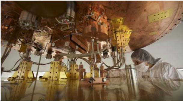
Figura 2: Il criostato di CUORE capace di raffreddare a 10 mK circa 740 kg di rivelatori termici per lo studio dei decadimenti rari del Tellurio.
