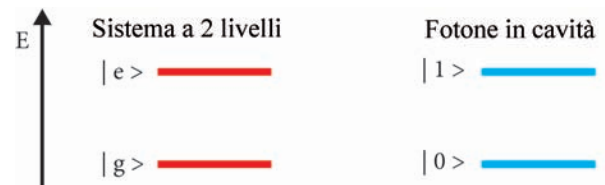
Figura 8: Stati energetici dell'elettrone in un sistema a due livelli e stati di Fock del fotone in cavità.
