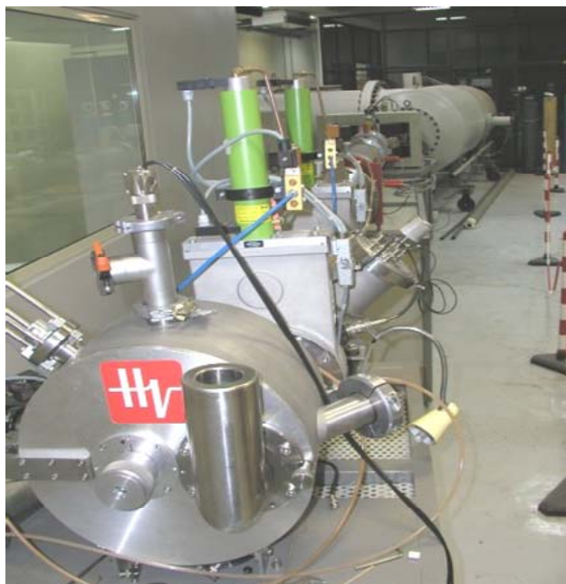
Fig. 2. The ion Implanter.
