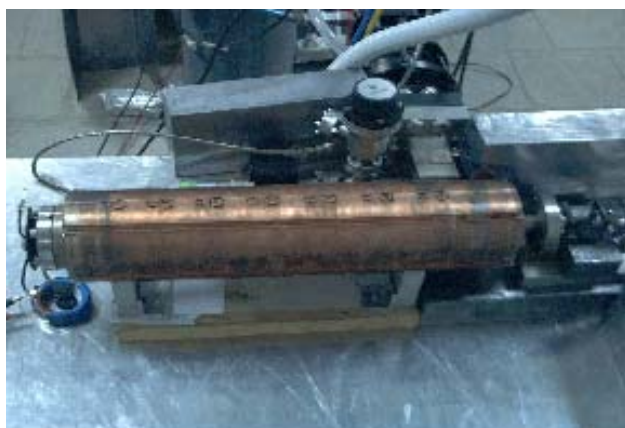
Fig. 2. The ion Implanter.
