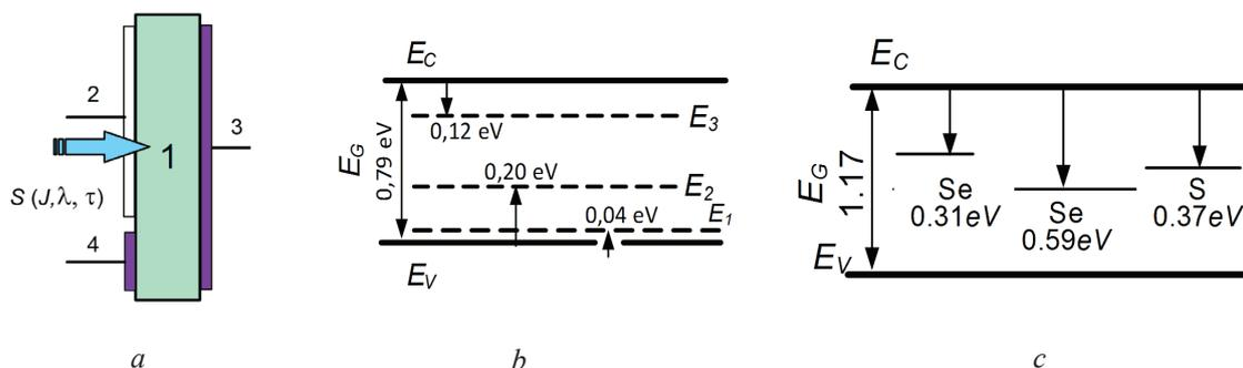
**Рисунок 2** – Конструкция ФЭП (а) и энергетические диаграммы собственного полупроводника: (b) Ge, легированного Pt ( $E_1, E_2, E_3$  – энергетические уровни платины в зарядовых состояниях  $(-2, -1), (-3, -2), (-1, 0)$  eV) и энергетические уровни примесей Se и S в кремнии (с)
