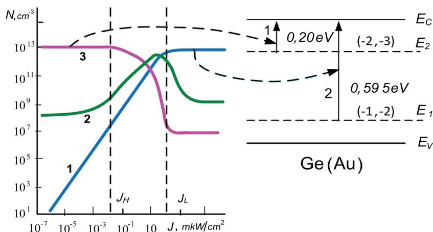
**Рисунок 4** – Зависимости концентрации ионов меди в германии n-типа в зарядовых состояниях (-3), (-2), (-1), линия 3, 2 и 1 соответственно от плотности мощности оптического излучения (справа энергетическая диаграмма; зарядовые состояния приведены в скобках)
