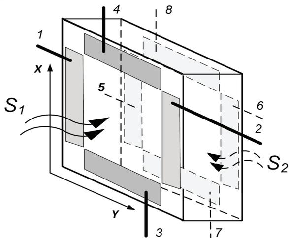
**Рисунок 7** – Оптико-электронный компаратор на базе одноэлементного двухбарьерного координатно-чувствительного ФЭП: 1–4 – совокупность электродов на стороне А; 5–8 – совокупность электродов на стороне В;  $S_1, S_2$  – оптические сигналы
