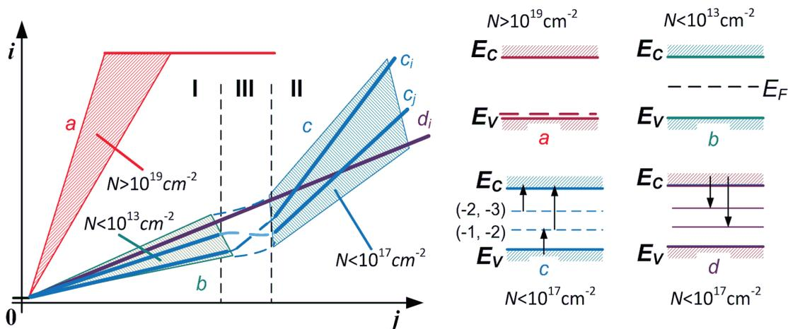
**Рисунок 5** – Энергетические характеристики ФЭП с примесной (a) и собственной (b) проводимостью, с многозарядными примесными центрами акцепторного (c) и донорного (d) типа; и соответствующие энергетические диаграммы материалов этих ФЭП
