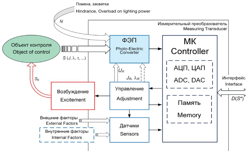
Рисунок 1 – Измерительный преобразователь системы оптической диагностики
