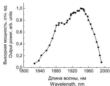
Рисунок 7 – Перестроечная кривая лазера на кристалле Tm:KLuW
