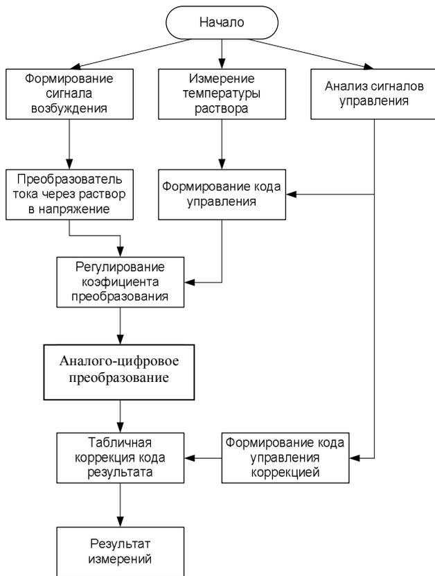
Рисунок 4 – Алгоритм измерения концентрации раствора
