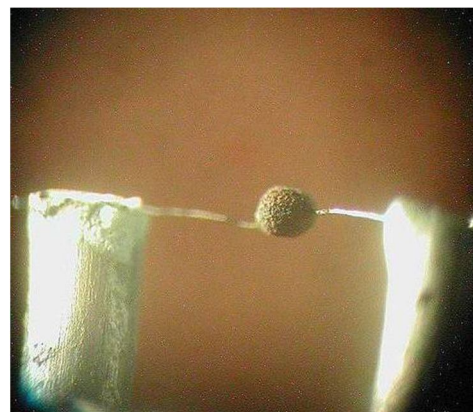
Рисунок 1 – Внешний вид термокаталитического сенсора разваренного в корпус
