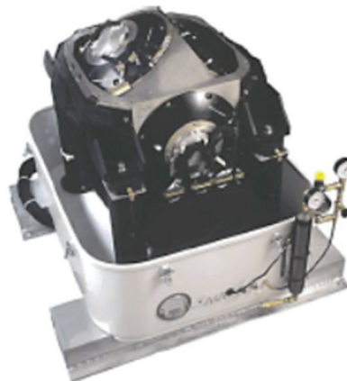
Рисунок 4 – Сборка всех трех дисков в карданном подвесе прибора Air-FTG [29, 61]
