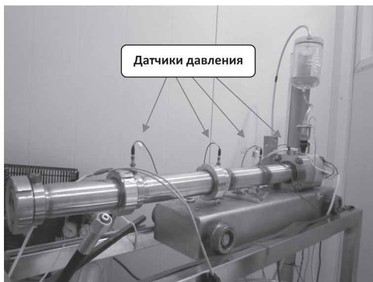
Рис. 1. Общий вид импульсной детонационной камеры сгорания на жидком топливе
