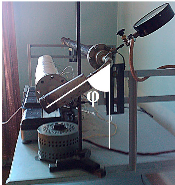
Рис. 5. Отклонение испарителя от вертикальной плоскости на угол \varphi (за изначальное принимается вертикальное положение термосифона) Fig. 5. Inclination of the evaporator from the vertical plane by an angle \varphi (the initial position is vertical position of the thermosyphon)
