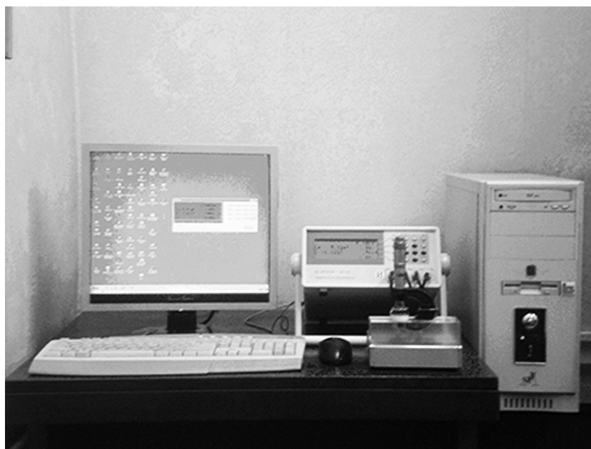
Рис. 1. Экспериментальная установка для контроля и диагностики электрических свойств композитов на основе ВПЭ в диапазоне частот электрического поля 50 Гц – 1 МГц
