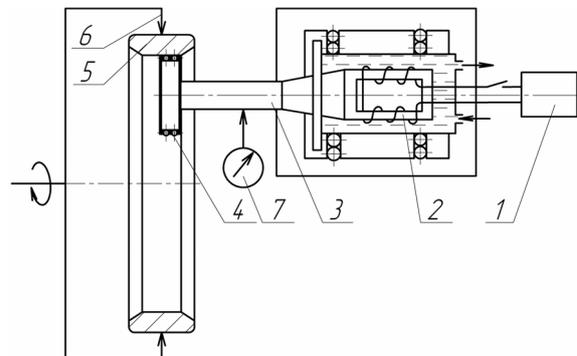
Рис. 5. Схема устройства ультразвуковой ударной обработки внутренней поверхности
