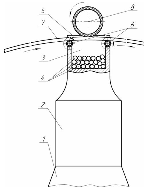
Рис. 4. Схема устройства для поверхностного ультразвукового упрочнения плоских упругих элементов с насыпными деформирующими шариками
