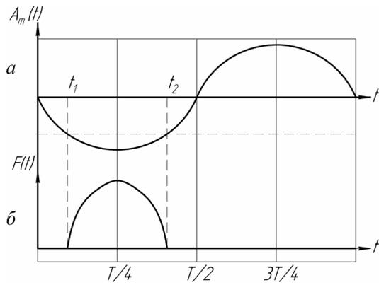
Рис. 3. Характер движения деформирующего элемента (а) и зависимость сил, действующих в процессе его контакта с обрабатываемой поверхностью (б), от времени
