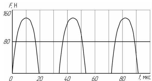
Рис. 2. Зависимость силы прижима от времени
