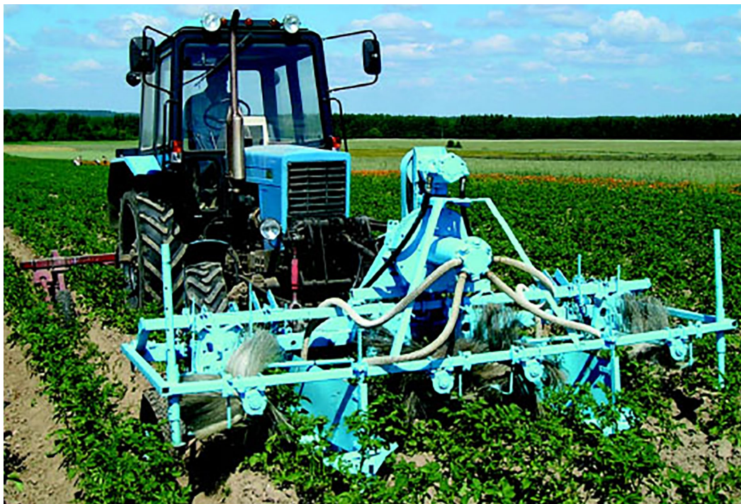
Рис. 10. Комбинированный агрегат для сбора колорадского жука и окучивания картофеля в работе Fig. 10. Operation of combined unit for collection of Colorado beetle and potato hilling
