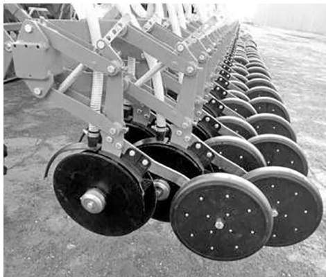
Рис. 5. Двухдисковые сошники с минимальным углом атаки дисков, с прикатывающим катком (ЕС) – 3.1.1.2.1.2.3.7.4.2.3.3.3.2.1.4.2.2.2.3 Fig. 5. Double disc coulter with minimal approach angle, with press wheel (EU) – 3.1.1.2.1.2.3.7.4.2.3.3.3.2.1.4.2.2.2.3
