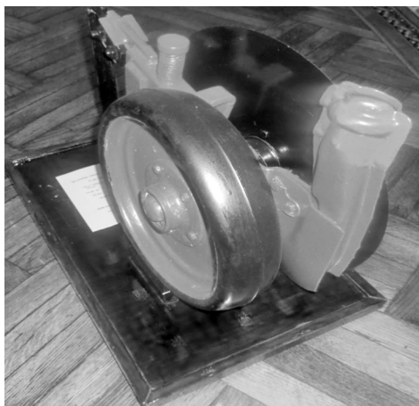
Рис. 2. Однодисковый сошник с опорно-прикатывающим каточком (Республика Беларусь) – 3.1.8.5.1.2.3.6.4.2.3.2.3.2.1.5.3.2.2.3
