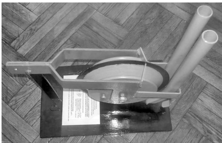
Рис. 3. Однодисковый сошник с двухсторонними усеченно-конусными ребрами-бороздкообразователями (Республика Беларусь) – 3.7.9.4.1.2.3.4.3.5.3.2.1.2.1.1.5.3.5.1
