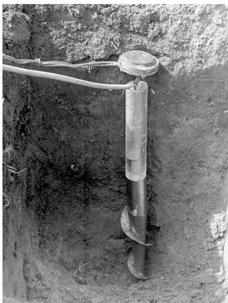
Рис. 4. Прибор для одновременного замера напряжений и осадки почвы под воздействием многоосной ходовой системы
