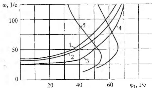
Рис. 6. Графическое определение частоты автоколебаний. 1, 2, 3 – зависимость  $\omega = f(\varphi_1)$  из (29) для: 1 – системы без асимметрирования по току; 2 – с асимметрированием по току при  $T_\Phi = 0,5 \text{ с}$ ; 3 – с асимметрированием по току при  $T_\Phi = 0,1 \text{ с}$ ; 4, 5 – фазочастотные характеристики звена  $W_{k1}(P) = (0,1P + 1)(G_1 0,01P + 1)^{-1}$  при  $G_1 = 0,05, G_2 = 0,1$
