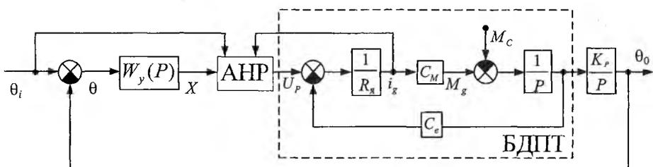
Рис. 4. Структурная схема следящей системы с АНР
