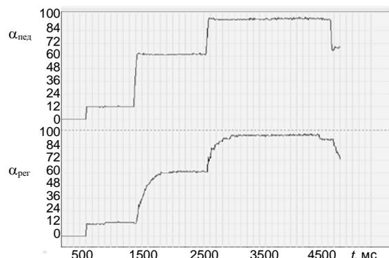
Рис. 10. Осциллограмма процесса управления топливоподачей при неработающем двигателе
