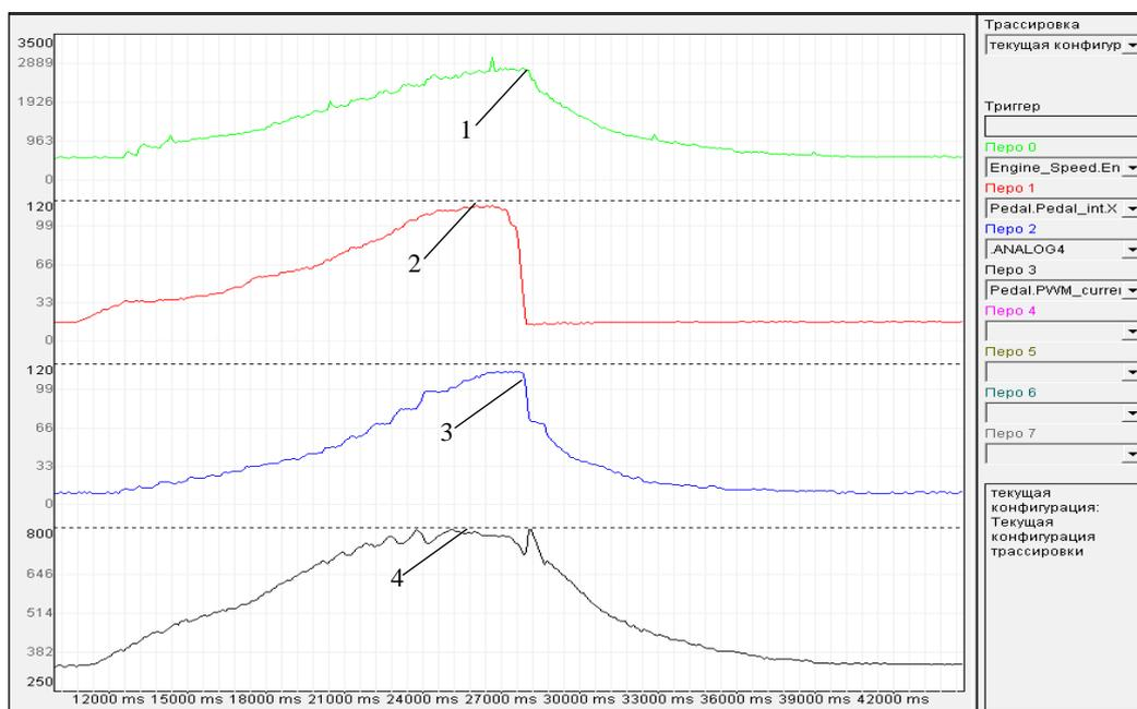
Рис. 11. Осциллограмма процесса управления топливоподачей двигателя внутреннего сгорания:
