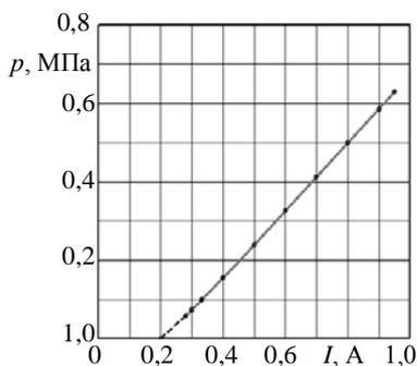
Рис. 3. Характеристика «ток – давление» пропорционального электромагнитного клапана SMC VEP3121-1
