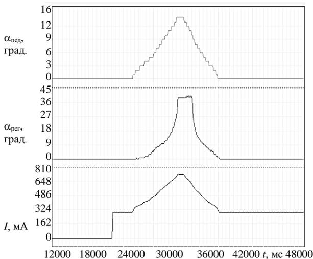
Рис. 6. Осциллограмма процесса электронного управления топливоподачей:  $\alpha_{пед}$  – угловое положение педали акселератора;  $\alpha_{рег}$  – угловое положение рычага регулятора топливного насоса высокого давления;  $I$  – ток на обмотках пропорционального электромагнитного клапана;  $t$  – текущее время
