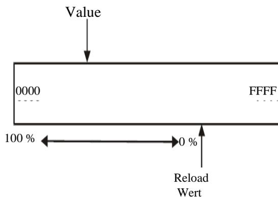
Рис. 4. Принцип формирования широтно-импульсного сигнала
