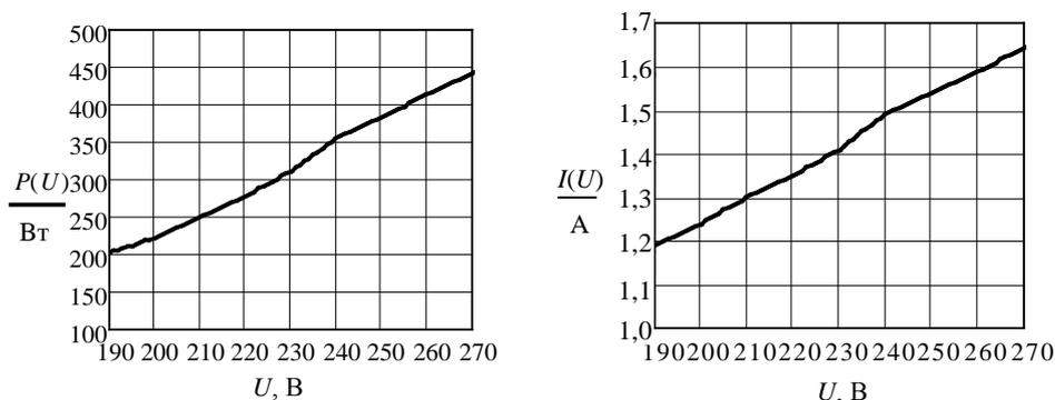
Рис. 1. Зависимости активной мощности (с учетом потерь в ЭмПРА)  $P(U)$  и полного тока (с учетом компенсации)  $I(U)$  светильника с лампой типа ДНаТ с компенсированным ЭмПРА номинальной мощностью 278 Вт от напряжения сети
