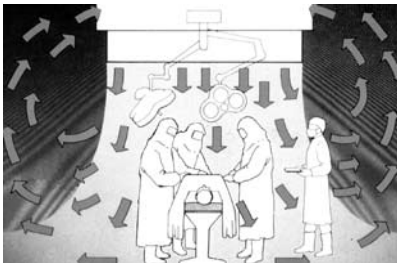
Figuur 12b: Schema van een zogenaamde "exponentiele flow" waarbij de lucht met vooral centraal hoge snelheid wordt ingeblazen om een gegarandeerde en stabiele downflow te kunnen verkrijgen. De schone lucht voert alle kleine gestrooide besmette partikels weg van de operatietafel. Het operatieteam kan zich nog extra isoleren door gebruik te maken van helmen.
