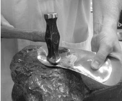
Figuur 7: Bijkloppen van een metalen steunzool op een klomp lood om de vorm aan te passen aan de wensen of noden van een patiënt. Ouderwetse methode.
