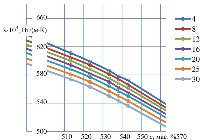
Рис. 1. Зависимость теплопроводности растворов  $\text{BeCl}_2$  от концентрации при различных температурах
