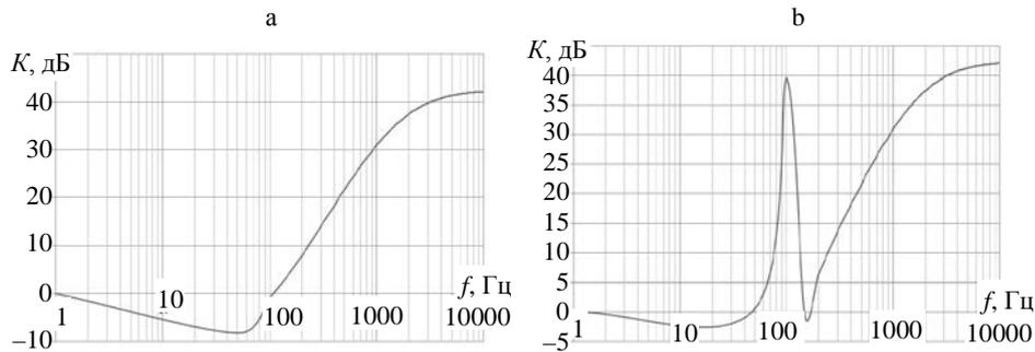
Рис. 3. Логарифмические амплитудно-частотные характеристики системы управления комбинированного активного фильтра без селективного звена (а) и с учетом его действия (б)
