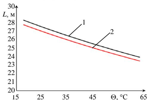
Рис. 2. Зависимость  $L = f(\Theta)$  при  $\Delta U_{\text{доп}} = 1,5 \%$  для проводника:
