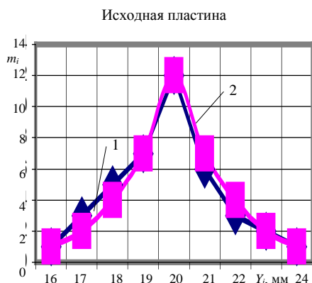
Рис. 4. Эмпирический полигон и кривая нормального распределения параметра стойкости для исходной СНП: 1 – эмпирический полигон; 2 – теоретическая кривая нормального распределения
