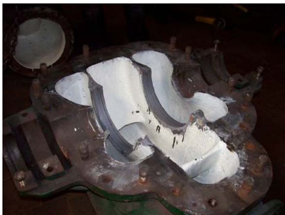
Рис. 1. Корпус насоса Д1250 с восстановленными мультиметаллом посадочными поверхностями под диффузорные кольца и защитным химически стойким композитным покрытием
