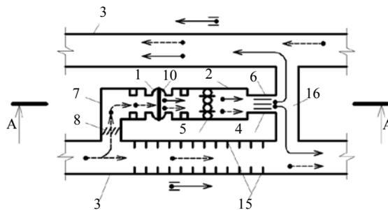
Рис. 1. Устройство реверсивной тоннельной вентиляции метрополитенов с частичной рециркуляцией воздуха:  $\Rightarrow$  – направление движения поезда;  $\bullet \rightarrow$  – то же потоков воздуха системы вентиляции;  $\circ \rightarrow$  – то же циркуляционных воздушных потоков;  $\dashrightarrow$  – то же удаляемого в атмосферу воздуха
