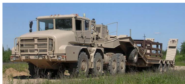
Рис. 1. Тягач со стеклопластиковой кабиной, оперением и капотом
