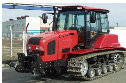
Рис. 2. Трактор со стеклопластиковой крышей, капотом и оперением
