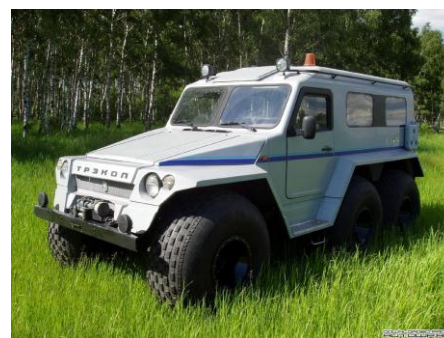
Рис. 3. Вездеход со стеклопластиковым кузовом, капотом и оперением
