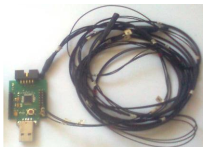
Рис. 4. Специальный контроллер с выводом через USB диагностической информации на внешний носитель, разработанный для мобильной системы мониторинга
