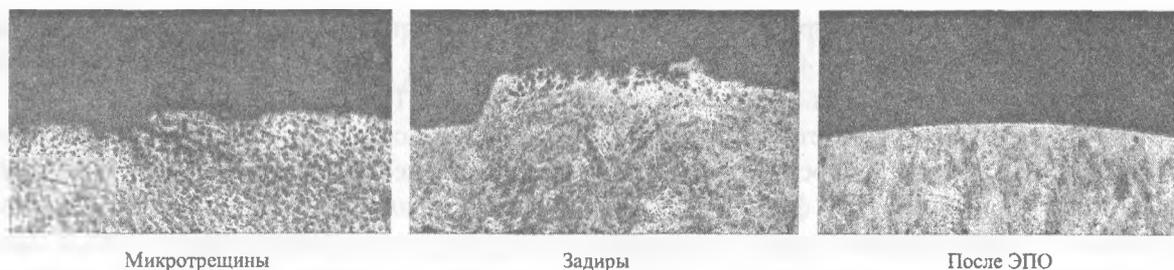
Рис. 2. Структура поверхности деформированного материала до и после ЭПО,  $\times 200$
