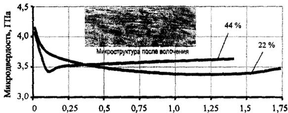
Рис. 1. Распределение микротвердости в поперечном сечении при различных суммарных степенях деформации
