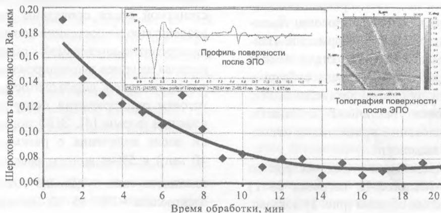
Рис. 3. Влияние продолжительности ЭПО на шероховатость поверхности
