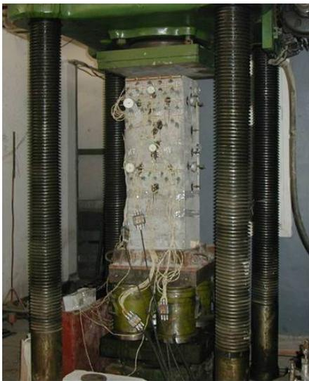
Рис. 3. Общий вид испытаний нагружением опытных фрагментов колонн
