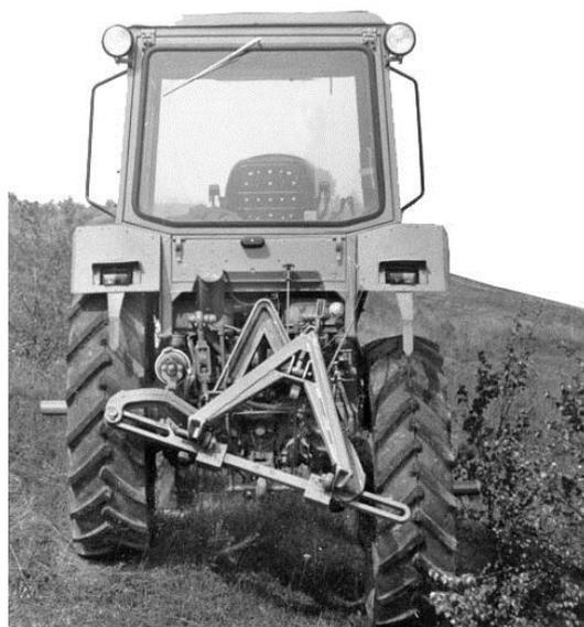
Рис. 11. Горно-равнинный трактор с механизмами автоматической стабилизации остова в вертикальном положении и корректировки сельхозмашины параллельно поверхности поля на склоне
