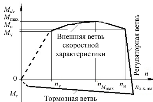
Рис. 8. Характер скоростной характеристики дизеля со всережимным регулятором при тяговом и тормозном режимах: M – моменты двигателя; n_y – устойчивая частота вращения; n_{M_{max}} – частота вращения при максимальном моменте; n_n – то же на номинальной мощности; n_{x.x.max} – то же максимальная холостого хода
