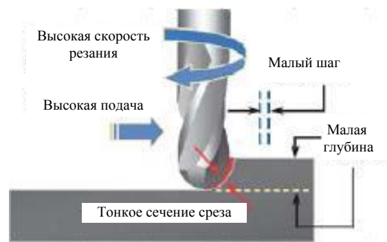
Рис. 2. Параметры резания для высокоскоростной обработки
