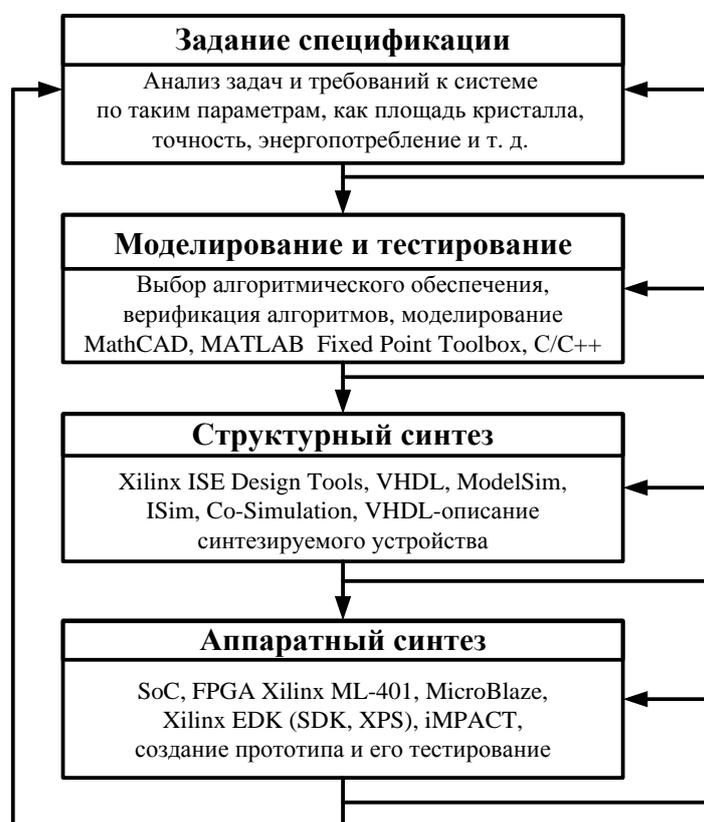
Рис. 3. Этапы быстрого прототипирования программируемых систем-на-кристалле ПЛИС
