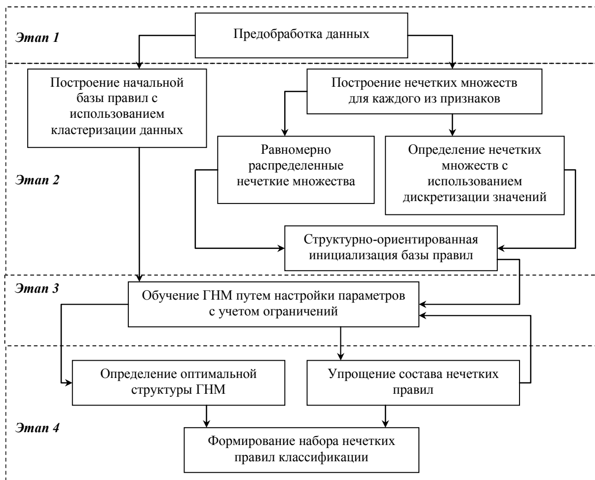
Рис. 3. Обобщенная схема этапов построения ГНМ
