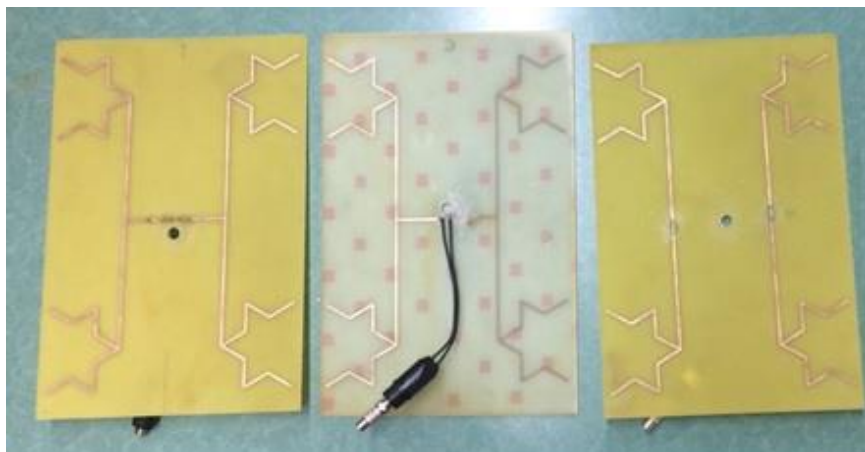
Figura 3 – Antenas fractales construidas de izquierda a derecha: AFTCL_1, AFTCL_2 y AFTSL_1.
