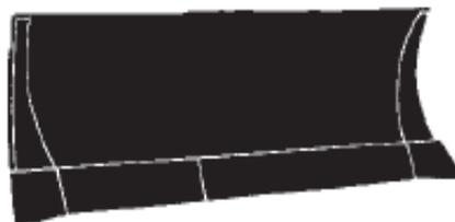
**FIGURA 15 Hoja orientable y angulable (Manual de rendimiento de Caterpillar, Ed. 31)**
