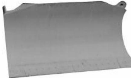
**FIGURA 16 Hoja orientable e inclinable (Manual de rendimiento de Caterpillar, Ed. 31)**
