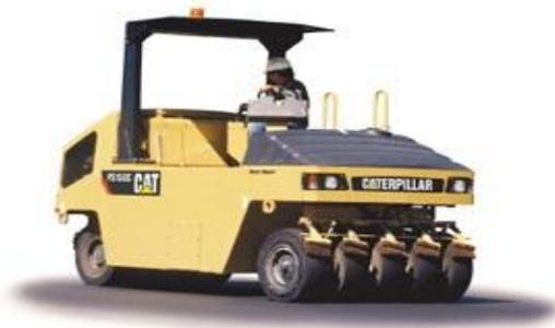
FIGURA 26 Compactadora Neumática ([www.cat.com](http://www.cat.com))
