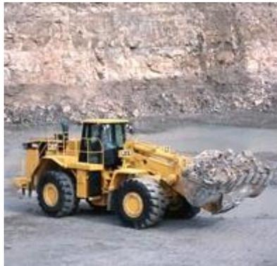
**FIGURA 20 Cargador con ruedas ([www.cat.com](http://www.cat.com))**
