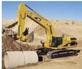
**FIGURA 22 Retroexcavadora con orugas (www.cat.com)**
