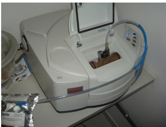
Figura 1: Espectrômetro com a célula acoplada.
