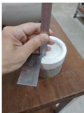
Figura 11. Medição de profundidade de camada de extração com paquímetro
