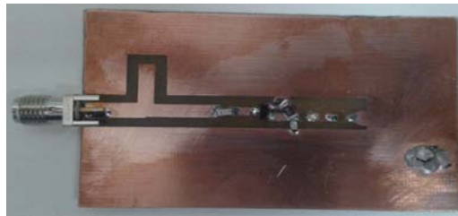
Figura 6. Circuito otimizado do retificador em conjunto com o circuito de casamento de impedância.
