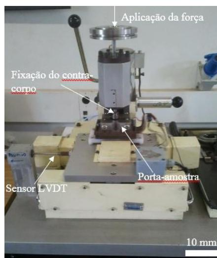
Figura 1: Imagem do tribômetro Plint TE67 utilizado nos ensaios de desgaste.
